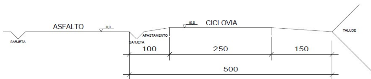
Figura 1: corte transversal do terreno.
